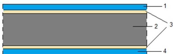
Рисунок 1. Конструкция многослойного нетканого материала: 1 – верхнее трикотажное полотно, 2 – клеевой слой, 3 – волокнистые отходы, 4 – нижнее трикотажное полотно.
