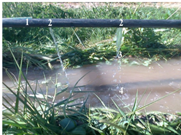
Рисунок 1. Общий вид экспериментальной установки: 1-труба для подачи патока стоков; 2-отверстия.
