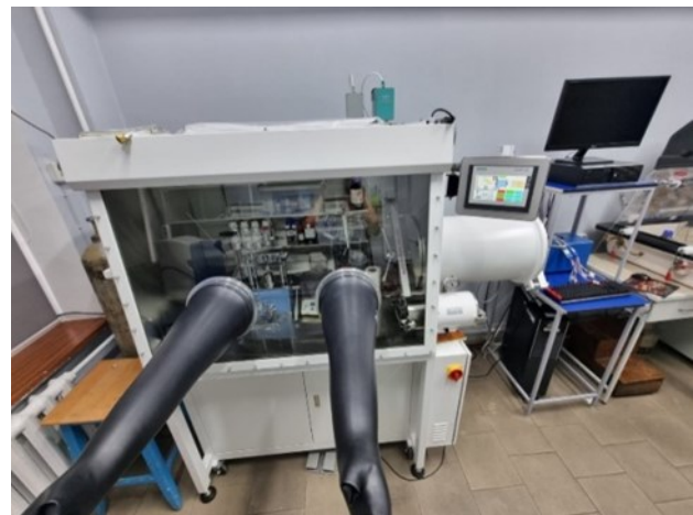
Рисунок 2. Фотографии перчаточного бокса с инертной атмосферой для испытания катодных материалов в электролитах на циклируемость.
